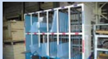
目視検査ミスを防ぐために、リコーの規格品とそれ以外に分類
